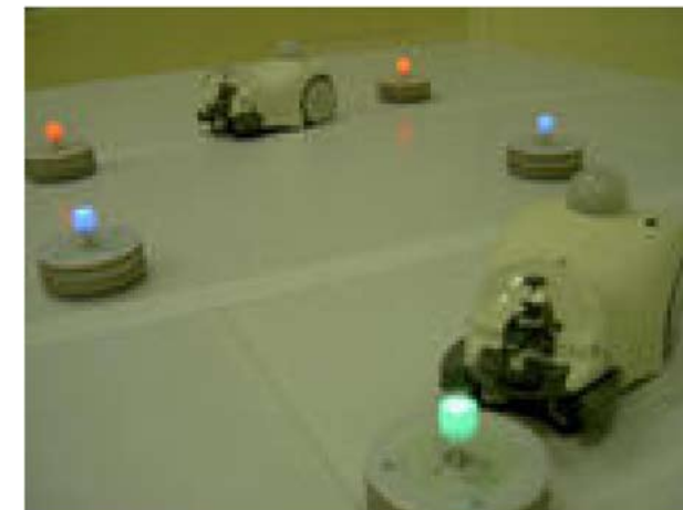
図5. サイバーローデント 実際の生物と同じ自己保存と自己複製という条件のもとで、生存し交配するロボット「サイバーローデント」を開発しました。体長22センチ、重さ1.75 キログラムのロボットで全方位視覚システム、近接距離センサー、加速度センサー、ジャイロセンサーなど多様なセンサーを持っています
